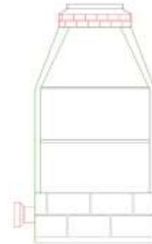
**Cone de concreto, Cone C-60 :**
